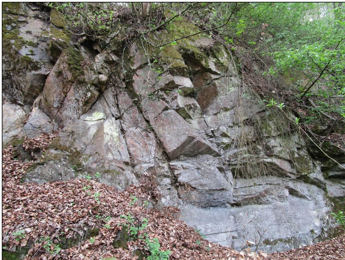
obr. č. 25 Skalní stěna za výjezdovým portálem, hornina je blokovitě odlučná se střední hustotou diskontinuit - 600 mm
